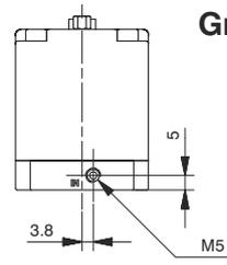
\* = ANSCHLUSS FÜR EXTERNES DRUCKSIGNAL (NUR VERFÜGBAR BEI AUSFÜHRUNG MIT EXTERNEM DRUCKSIGNAL)
